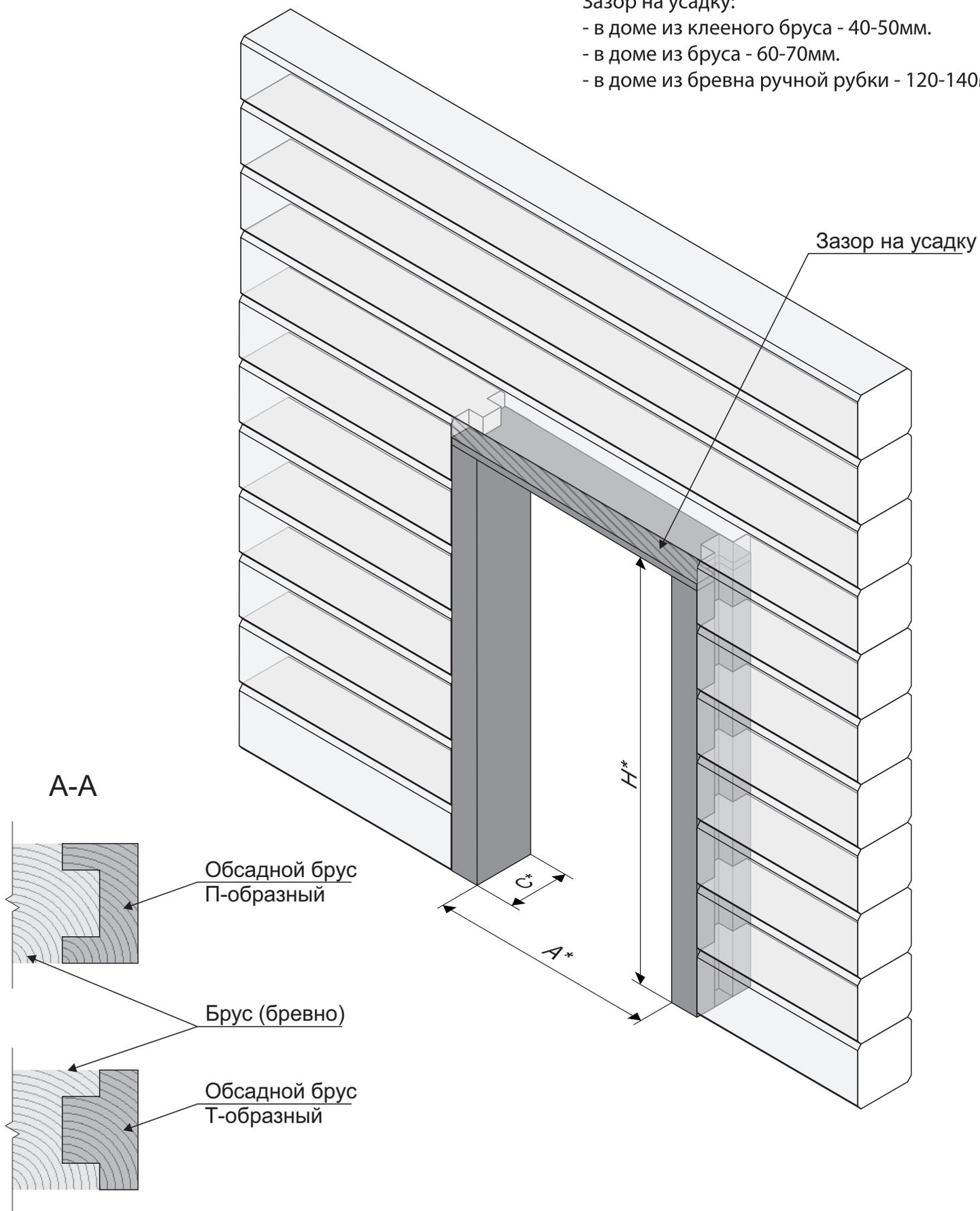
\* размеры в соответствии с таблицами из технических требований по строительной подготовке дверных проемов и помещений. Зазор на монтажную пену не более 30мм.
